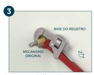
Com uma chave de cano (grifo), retire o mecanismo do registro defeituoso da parede.
