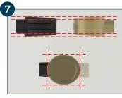
Identifique a cunha emborrachada que mais se aproxima da cunha do mecanismo original. Compare a altura, largura e espessura de ambos os mecanismos.
