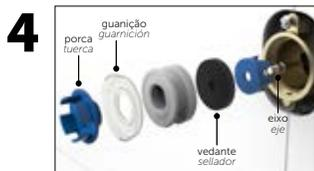
4 Com o pistão (349432) retirado, solte a porca (19) e substitua a guarnição (20), em seguida, desrosque o eixo (25) e substitua o vedante (22).
