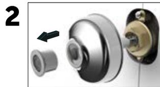
2 Dê a descarga para saída do restante d'água e retire o preme (1) para remover a canopla (2).
