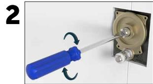
2 Feche o registro integrado por meio do eixo (6). Dê a descarga para saída do restante d'água.
