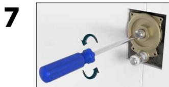
7 Com o registro geral do banheiro aberto, regule a vazão da descarga abrindo o eixo (6) até encontrar o tempo e volume de descarga ideal.
