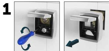
1 Remova o acabamento (340309) retirando os parafusos de fixação (3).
