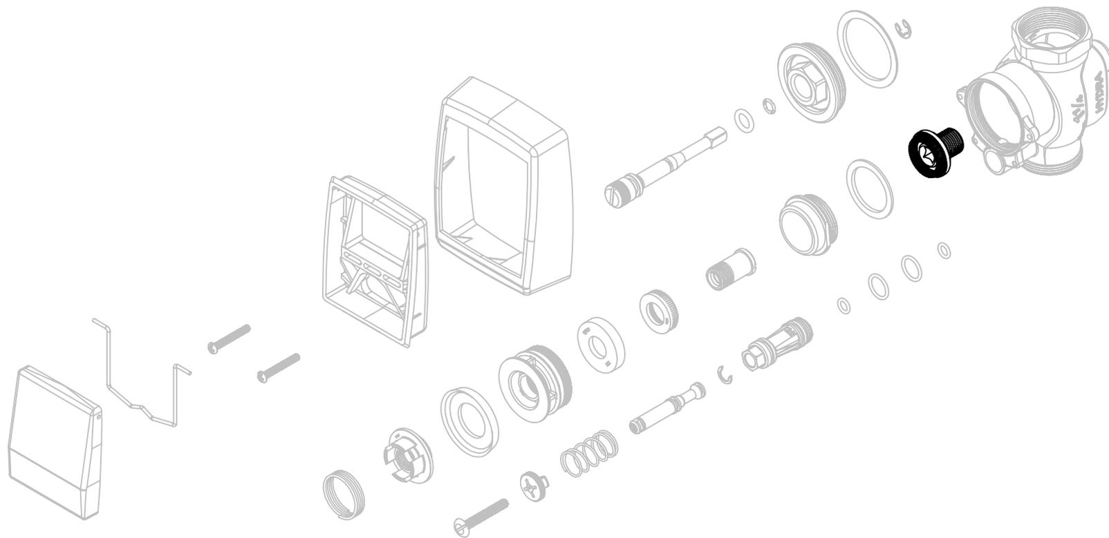
VISTA EXPLODIDA DO PRODUTO NA SEQUÊNCIA DE MONTAGEM DA VÁLVULA DE DESCARGA
