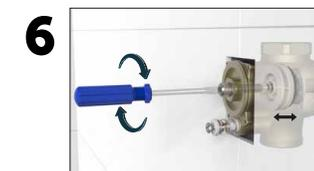
6 Com o registro geral do banheiro agora aberto, regule a vazão da descarga abrindo ou fechando o registro integrado da válvula até encontrar o tempo de descarga ideal.
