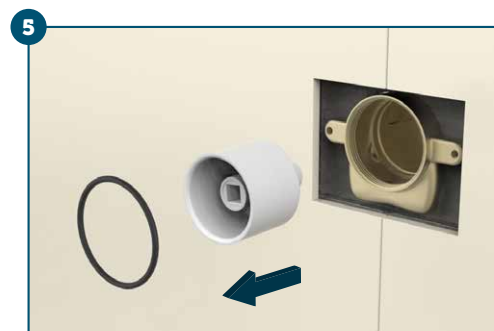
5 Caso seja necessário trocar a contra sede (341606), após fechar o registro da coluna de água retire o anel (12) e remova a sede com uma ferramenta. Si es necesario, cambiar la contra base (341606) después de cerrar la válvula de la columna de agua retire el anillo (12) y retire la base con una herramienta.
