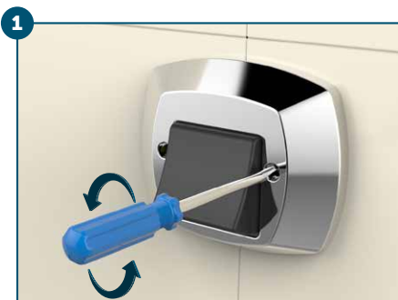
1 Remova o acabamento (340307, 340308, 340344, 340346, 340348) retirando os parafusos de fixação (2). Retire el acabado (340307, 340308, 340344, 340346, 340348) retirando los tornillos de fijación (2).
