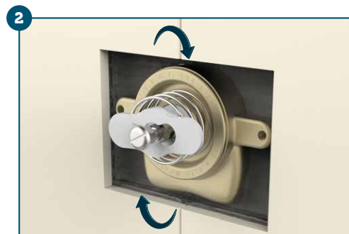
2 Feche o registro integrado por meio da trava (7). Dê a descarga para saída do restante d'água. Cierre la válvula integrada por medio de la traba (7). Efectúe la descarga para la salida del resto de agua.
