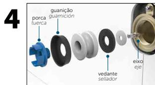
4 Com o pistão (349435) retirado, solte a porca (18) e substitua a guarnição (19 ou 20), em seguida, desrosque o eixo (24) e substitua o vedante (22).
