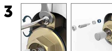
3 Solte a porca (26) com a ajuda de uma chave de fenda, desrosqueie o parafuso injetor (349423) e troque as vedações ou o injetor completo. **NOTA:** Realize a limpeza do interior do canal, desobstruindo a passagem de resíduos.
