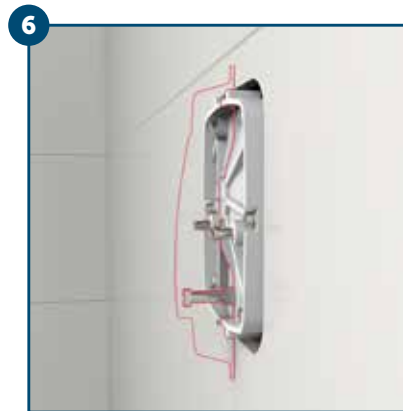
Figura 1 Instalação sobreposta Instalación superpuesta
