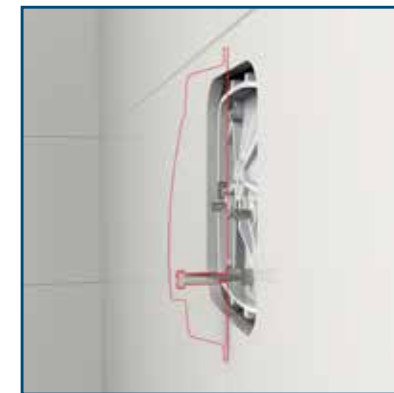
Figura 2 Instalação embutida Instalación empotrada
