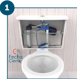
Feche a válvula de alimentação da caixa de descarga.
