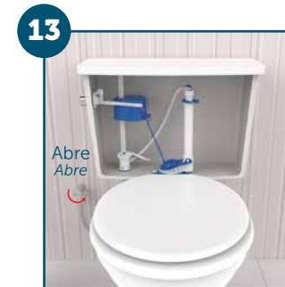
Reabra a válvula de alimentação da caixa de descarga.
