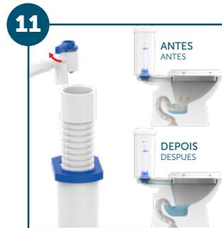
Encaixe a válvula de reposição do fecho hidráulico no tubo extravasor (ladrão). A válvula repõe a quantidade de água no fundo do vaso sanitário após a descarga, evitando o retorno de maus cheiros.
