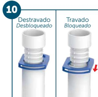
Firme o tubo extravasor (ladrão) e mova a trava de fixação.
