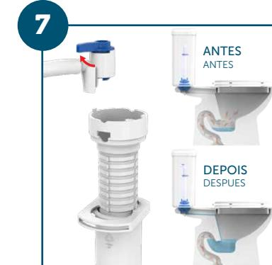
Encaixe a válvula de reposição do fecho hídrico no tubo extravasor (ladão). A válvula repõe a quantidade de água no fundo do vaso sanitário após a descarga, evitando o retorno de maus cheiros.
