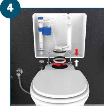
No mesmo furo de onde foi removido o defeituoso, instale o novo mecanismo Blukit e reinstale a caixa de descarga no bacia.
