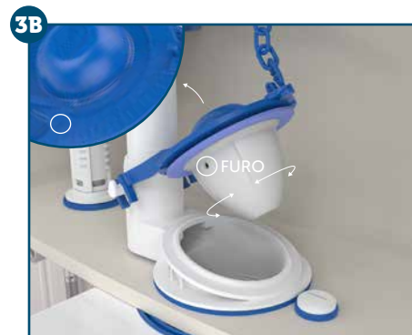
Quanto mais próximo o furo lateral estiver do número 10, maior a quantidade de água gasta e mais lento o fechamento. Cuanto más cerca el orificio lateral estuviere del número 10, mayor la cantidad de agua gastada y más lento el cierre.
