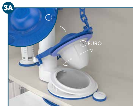
Quanto mais próximo o furo lateral estiver do número 1, menor a quantidade de água gasta e mais rápido o fechamento. Cuanto más cerca el orificio lateral estuviere del número 1, menor la cantidad de agua gastada y más rápido el cierre.
