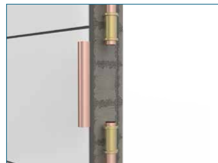
6. Posicione o novo tubo e mova as luvas conectando-as ao tubo na parede.
