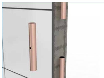
1. Corte e remova o segmento do tubo defeituoso.
