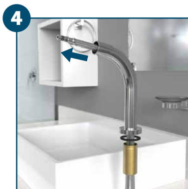
4 Passe as ligações flexíveis pelo vedante, niple de fixação e corpo do misturador. Pase las conexiones flexibles a través del sello, niple de fijación y cuerpo del mezclador.
