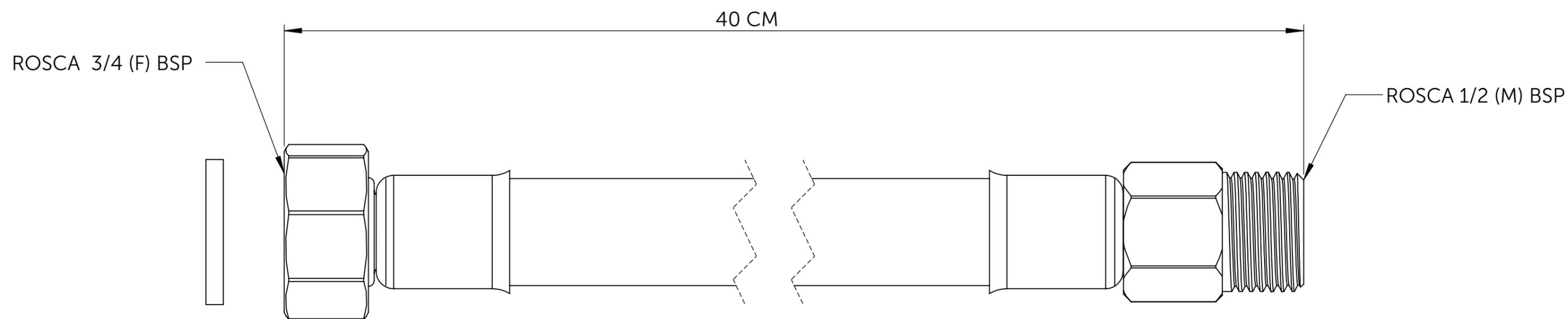
Descrição: Liga de Cobre, Elastômeros e Aço Inoxidável AISI 304
