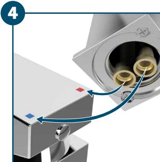
🔥 **ÁGUA QUENTE:** indicada pela marca vermelha à direita do volante.
