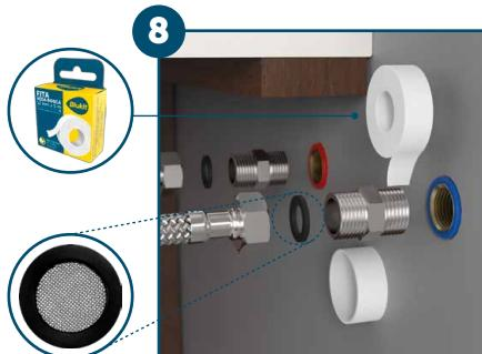
Aplique de 5 a 8 voltas de fita veda rosca **Blukit de 12 mm** em uma das extremidades dos nípates de modo que cada volta avance cerca de 0,5 cm em relação a volta anterior. Rosque-os nas tomadas d'água na parede e, a seguir, rosque as extremidades fêmeas das ligações flexíveis nos nípates.
