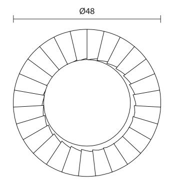
DESCRIÇÃO CATÁLOGO: Porca Para Válvula De Escoamento Para Lavatório De 7/8"
