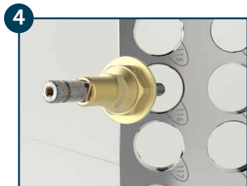
4 Segure o mecanismo pela extremidade que fica fora da parede e introduza a outra nos furos do gabarito de rosca Blukit até encontrar o furo que melhor se ajuste a rosca do mecanismo original. ATENÇÃO: certifique-se de que a rosca do módulo de redução fique perfeitamente ajustada à base do registro. Anote o número do furo do gabarito.
