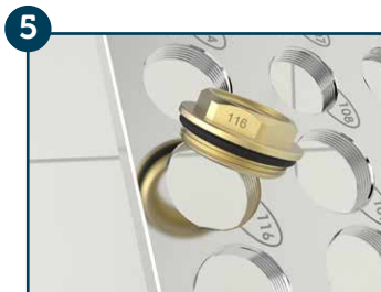
5 Identificado o número da rosca do gabarito, separe o módulo de redução de número correspondente.
