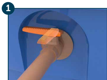
1 Feche o registro geral da caixa d'água.
