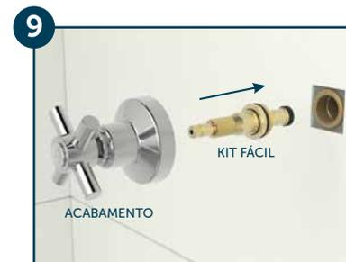
9 Reinstale o conjunto e reabra o registro geral. Obs.: após a instalação concluída, o acabamento original poderá ser mantido ou, caso seja conveniente, substituído por um modelo que seja compatível ao mecanismo do Kit Fácil de pressão.
