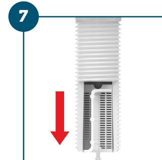
Retire o filtro do interior do mecanismo de entrada. **Obs.:** Caso o filtro não esteja instalado, não utilizar o produto.
