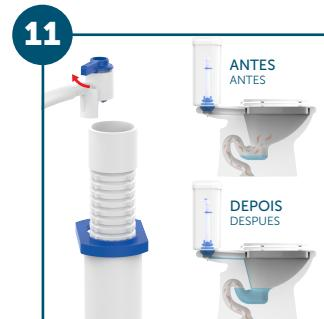
Encaixe a válvula de reposição do fecho hídrico no tubo extravasor (ladrão). A válvula repõe a quantidade de água no fundo do vaso sanitário após a descarga, evitando o retorno de maus cheiros.
