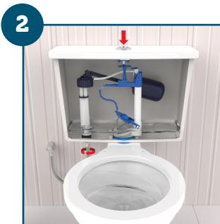
Esvazie a caixa de descarga (se necessário, limpe o interior da caixa) e desrosqueie a ligação flexível conectada ao mecanismo de entrada.
