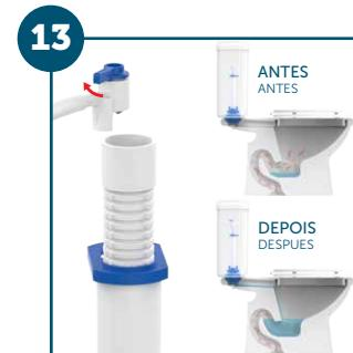
Encaixe a válvula de reposição do fecho hidráulico no tubo extravasor (ladrão). A válvula repõe a quantidade de água no fundo do vaso sanitário após a descarga, evitando o retorno de maus cheiros.
